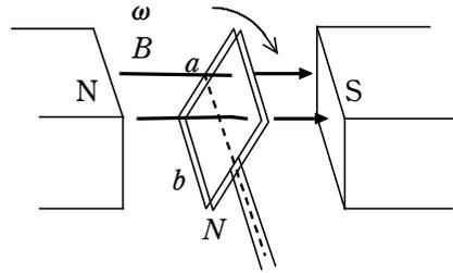
コイルを回転させると、コイル内の磁束に変化が起こるためにコイルに起電力が生じる。このときの発電の様子を調べてみよう。
