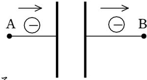
そのまま継続して電気力線がA→Bの向きであったなら、コンデンサーはやがて満タンになり、電流は流れなくなる。しかし、交流の場合しばらくすると電気力線の向きが逆になるので、満タンになった電子が逆に移動し、極板の両端で自由電子が振動できるのである。このようにして、コンデンサーを交流は流れることができる。
