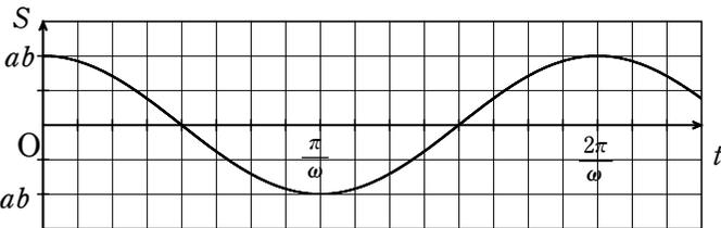
断面積が変化すると磁束が変化する。磁束の変化に伴い誘導起電力が生じるので、この装置は常に誘導起電力を生じていることになる。磁束の変化が最大になるところが
