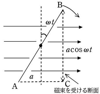
$BC$  面の面積はコイルが鉛直面から角速度  $\omega$  で回転し初めて  $t$  秒かかったとすると、その角度は  $\omega t$  で、断面  $BC$  の高さが  $a \cos \omega t$  となる。奥行きが  $b$  であるから、この断面の面積  $S$  は、 $S = ab \cos \omega t$  となる。
