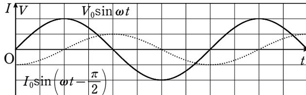
ずれの方向がコンデンサーとは逆方向である。時間的に電圧が最大になった後に電流が最大になるので、電流は電圧より位相が $\frac{\pi}{2}$ 遅れているという。
