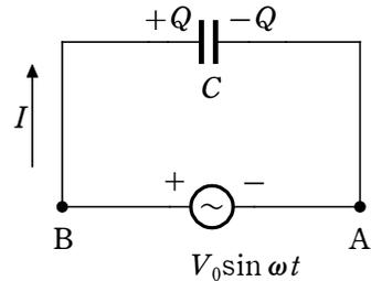
A点から、右回りに行くと、交流電源で電位が上がる。よって、B点の電位は $+V_0 \sin \omega t$ となる。B点から、コンデンサーを通してA点に行くには $\frac{Q}{C}$ だけ電位が下がる。
