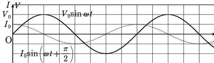
このグラフを見ると $V_0 = \frac{1}{\omega C} I_0$ の関係があるといえども位相が異なるため、瞬間ごとに $V = \frac{1}{\omega C} I$ が成り立っているわけではないのである。コンデンサーは電圧がかかったときに電流が流れるわけではなく、むしろ電圧がかかっていないときに電流が流れているのである。
