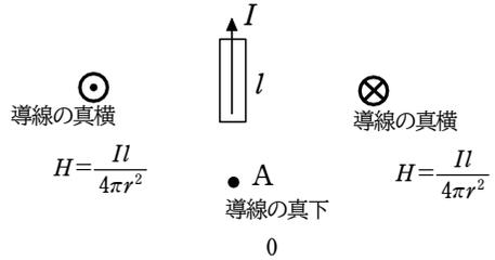
右図のように導線から、角度  $\theta$ 、距離  $r$  離れた点Cの磁場を求めてみよう。電流はベクトルであるため、分解が可能である。電流ベクトルを分解して考えると、導線OからCの方向の逆方向の成分とその直角成分に分解する。そのうち、OCと逆方向成分に対してCは電流の真下にあたるため、磁場をまったく生じない。磁場を生じるのは、OCと直角方向の電流である。その大きさは  $I \sin \theta$  である。この電流を用いると、C点の磁場は電流  $I \sin \theta$  の真横  $r$  離れた位置の磁場の強さになるため、
