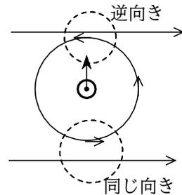
また、右向きに流れている電流に紙面向こうむきに磁場が存在している場合、電流の周りには右ねじの法則より電流の上では手前向き、下では向こうむきの磁場が生じ、電流は、磁場が逆向きになっている上の方に力を受ける。
