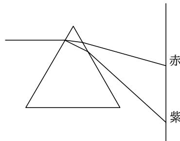
止まれの信号が赤いのも自動車のテールランプが赤いのも霧や空気中の塵の影響を受けにくい赤い光が使われているのである。波長の短い光ほど障害物によってはじかれやすい。障害物によって光がはじかれる現象を**散乱**という。青い光は空気中の塵によって、散乱されやすく遠くに届きにくい。空が青いのは空気分子によって青い光が散乱されたためである。
