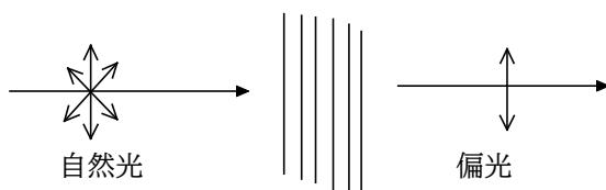
自然光に偏光板と呼ばれているスリットの入った物体を用いることにより、そのスリット方向のみに振動する偏光に変えることができる。
