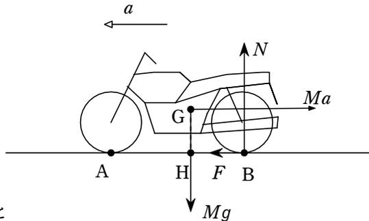
このオートバイが急加速すると、前輪が浮き上がることがある。そのときの加速度  $a$  およびそのために必要な静止摩擦係数  $\mu$  の最小値を求めよ。
