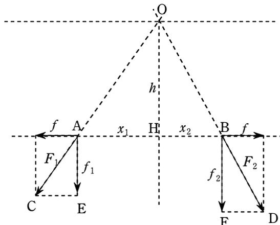
上の図は分かりやすくするために余分な力を取り除いてある。点Oから合力の作用線の向きに延長し、線分ABとの交点をHとする。AH= $x_1$ 、HB= $x_2$ とする。
