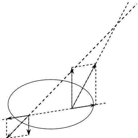
作用線の交点が見つかる。その交点に向けて力を移動させると、その2力の合成は可能である。
