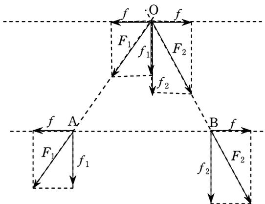
各分解した力の大きさは、力が A 点、B 点にあったときと同じであるから、水平方向が  $f$  鉛直方向が  $f_1$ 、 $f_2$  である。
