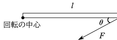
図のように回転の中心を黒点として、長さ $l$ の棒に対して角度 $\theta$ の方向に力 $F$ を加えた場合の力のモーメントを求めてみる。力の合成・分解は自由であるから、棒の方向とその直角方向に分解して考える。
