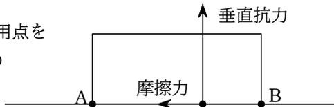
物体が回転していない場合は、摩擦力、垂直抗力を含めてモーメントのつり合いが成立している。モーメントが釣り合っている位置に垂直抗力、摩擦力の作用点があると考えられる。摩擦力の場合、面に沿うので面上のどこにあっても矛盾はないが、垂直抗力と同じ作用点と考えておくとよいであろう。
