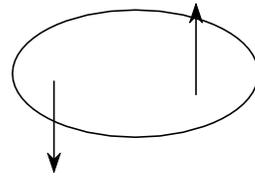
この場合、作用線が平行になってしまう。合成ができない。これはどういうことであろうか。こういった場合は実験を行なってみるとよい。物体を滑らかな机の上に置き、逆向きで同一直線上にない同じ大きさの力を同時に加えてみる。すると、物体は同じ位置で回転を始めることがわかる。言い換えれば、平行で逆向き同じ大きさの力を物体に加えると、物体はその場で回転を始めるのである。つまり、移動なしの回転のみである。このような力を**偶力**と呼んでいる。偶力は回転させるのみで移動させる能力はない。
