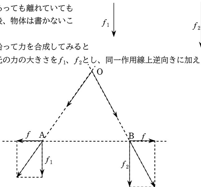
力  $f_1$ 、 $f_2$  の作用点を A、B とし、おのおの合成した力  $F_1$ 、 $F_2$  の作用線の交点を O とする。O 点に合成した力  $F_1$ 、 $F_2$  を移動する。次に O 点に移動した力を  $f$  に平行な力と、 $f_1$ 、 $f_2$  に平行な力に分解すると下の図のようになる。
