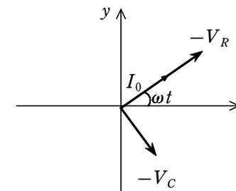
$$④ \quad V = RI_0\sin\omega t + \frac{I_0}{\omega C} \sin\left(\omega t - \frac{\pi}{2}\right)$$
