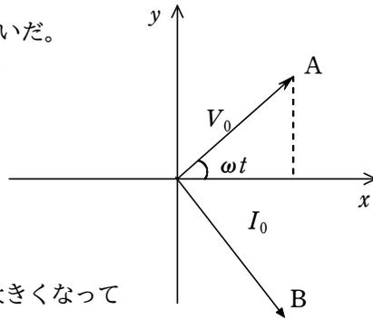
・  $xy$ 平面上に  $x$ 軸正の方向から角度  $\omega t$  をとり、大きさ  $V_0$  の原点を始点とするベクトル  $\vec{V}$  を書き込み、その終点を  $A$  とする。
