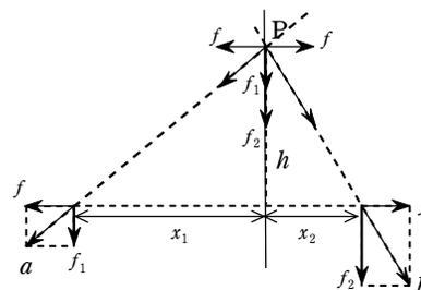
$f_1$ と $f$ を合成した力 $a$ と $f_2$ と $f$ を合成した力 $b$ をその作用線の交点Pまで平行移動する。点Pでこの力を再び $f_1$ と $f$ 、 $f_2$ と $f$ に分解する。 $a$ と $b$ の合力が求める合成した力であるが、同時に $f_1$ と $f$ 、 $f_2$ と $f$ の合力でもある。2つの $f$ が互いに逆向きであるから打ち消しあう。よって、この合力の方向は $f_1$ 、 $f_2$ と同じ方向になる。(①)
